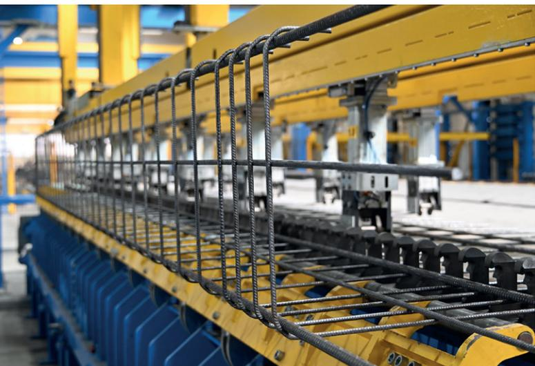
集成式梁筋弯曲系统确保钢筋笼的高效生产
