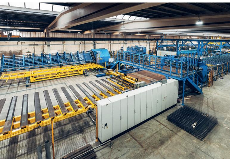
M-System PowerMesh 焊接生产线可高效生产间距与弯折可调的定制钢筋网片，同步实现产能提速与产量提升
