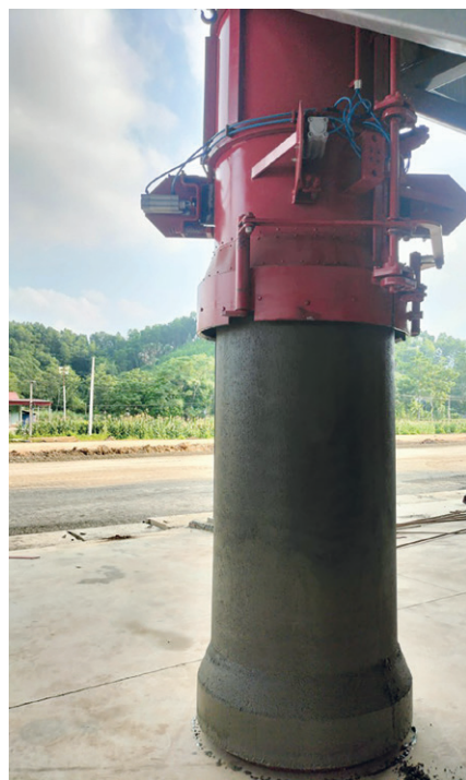
RP 1225-4 径向压力机首根混凝土管成功下线品质从第一步起就无可挑剔
