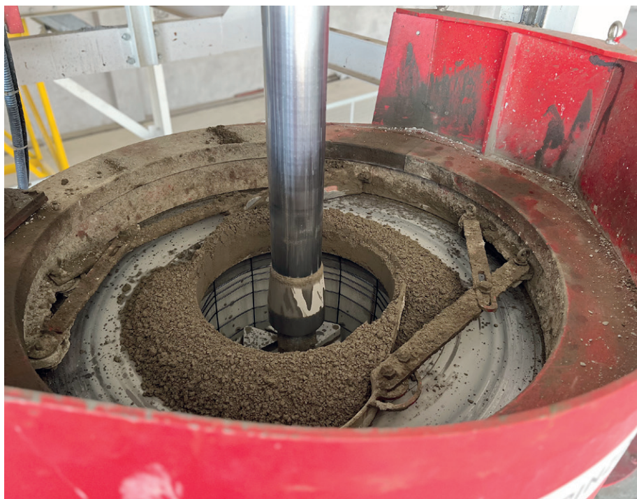
全球领先的径向挤压工艺混凝土制管实景
