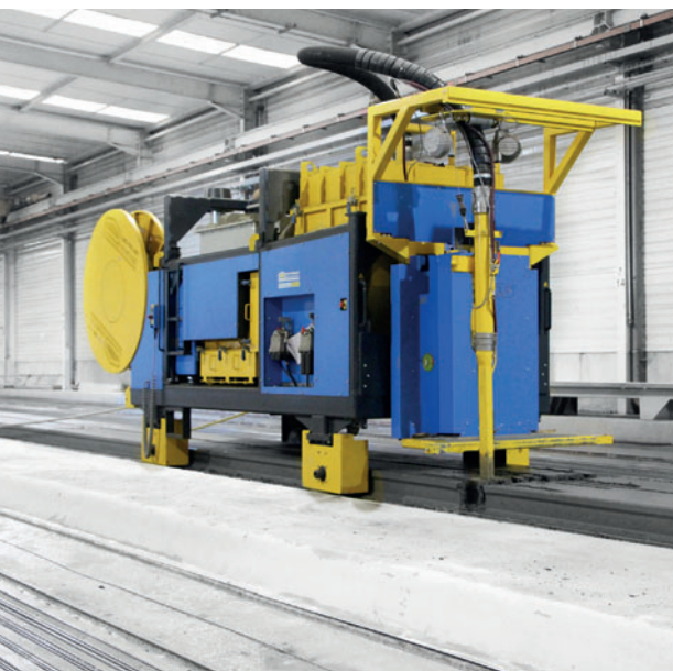
Установка для остсоса бетонной смеси даляет излишки бетона и тем самым снимает нагрузку с работников
