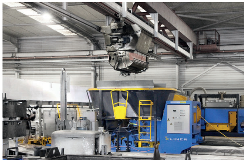
Слипформер S-Liner® обеспечивает автоматическое производство преднапряженных бетонных плит перекрытия с меньшим расходом цемента
