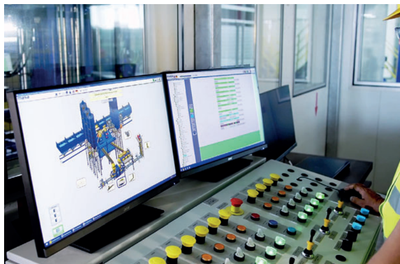
Визуализация производственной линии в программном обеспечении системы управления Masa
