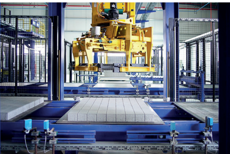
Сухая сторона I со станцией кубирования Cuboter: быстрая транспортировка и четкое пакетирование унифицированных изделий
