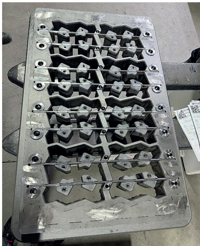
Форма для производства блоков газонной решетки с сердечниками из переработанного материала
