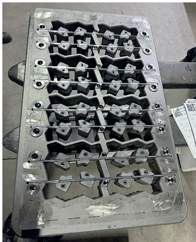
Forma do płyt ażurowych z rdzeniami wykonanymi z materiału pochodzącego z recyklingu.
