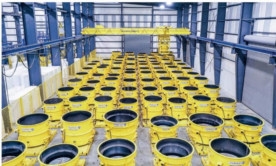
*Gli impianti di produzione flessibili di Schlüsselbauer, che colpiscono per la loro efficienza e per le loro prestazioni complessive, sono ora in uso in tutto il mondo. In due sedi di Ameritex Pipe & Products, ubicate nello stato federale del Texas, vengono installati impianti altamente automatizzati per la produzione di fondi per pozzetti su misura Perfect e di altri componenti realizzati con il procedimento in calcestruzzo liquido (Wetcast).*
