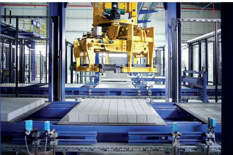
Lato asciutto I con Cuboter: movimentazione rapida ed impacchettamento accurato dei prodotti standard.
