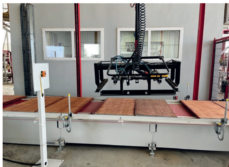
Pince de prélèvement pneumatique à 4 côtés ATZ-P4 à commande manuelle
