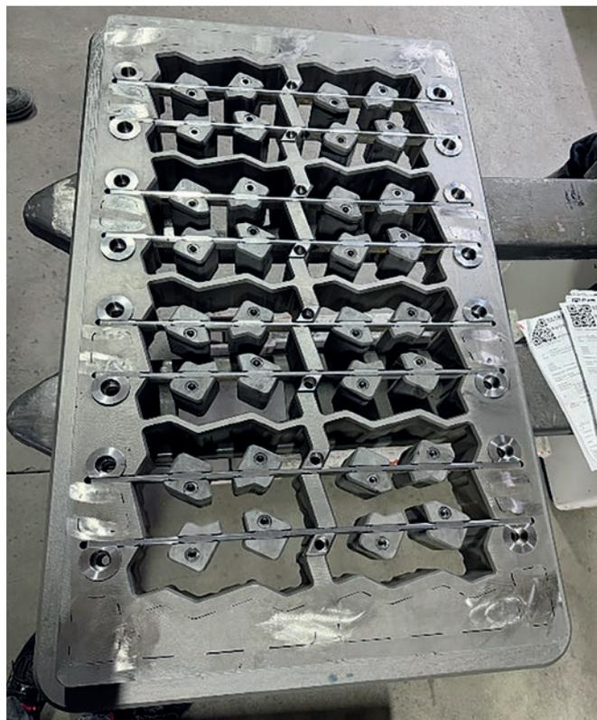
Moule pour grilles de gazon avec noyaux en matériaux recyclés
