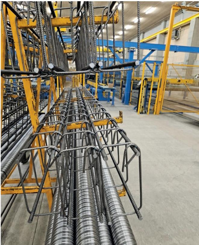
Grâce au système de cintrage innovant intégré dans l'installation de soudage de treillis, les cages peuvent être cintrées de manière entièrement automatique et flexible.
