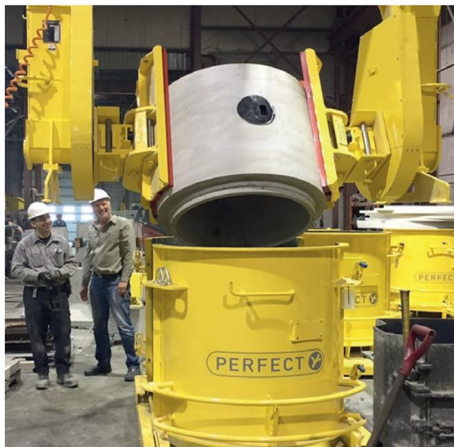
*Fortier 2000 Ltée comenzó en 2016 una ofensiva de calidad en el mercado canadiense de la ingeniería civil con la producción de bases para pozos de hormigón monolíticas y endurecidas con encofrado.*
