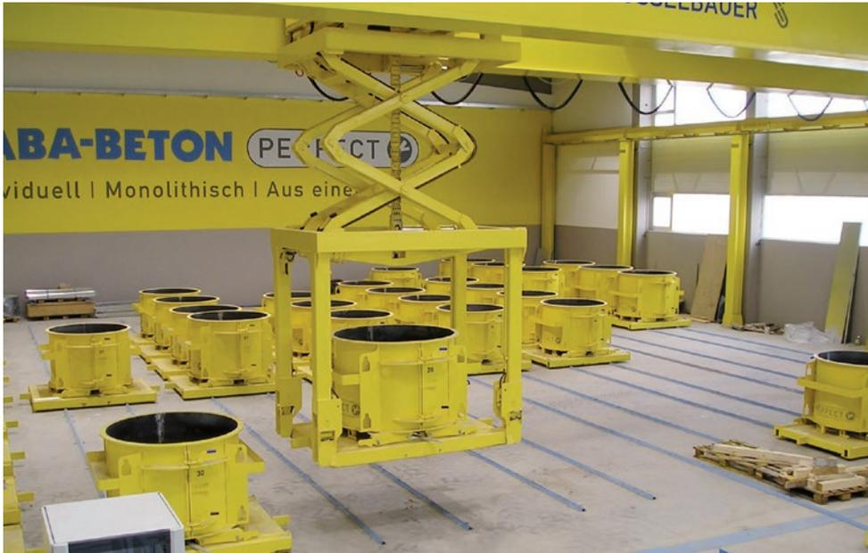
*Una de las primeras instalaciones de producción Perfect Base ampliamente automatizadas instalada en HABA Beton, uno de los proveedores líderes europeos de tubos de hormigón y pozos.*
