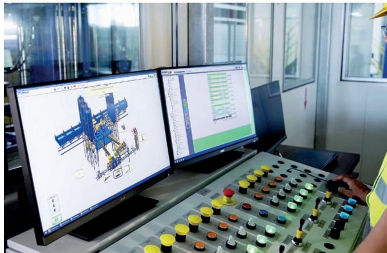
*Visualización de la instalación de producción en el software de control de instalaciones de Masa.*
