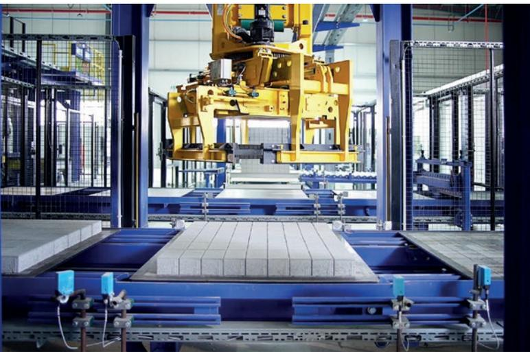
*Lado seco I con Cuboter: manipulación rápida y paletizado de los productos estándar.*
