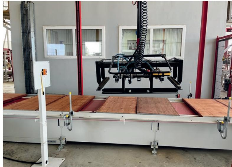
*Pinza ATZ-P4 de funcionamiento neumático manejada manualmente*
