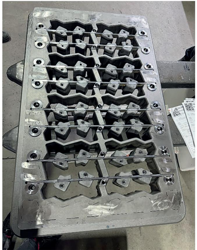
Molde para losas de celosía de césped con núcleos de material reciclado
