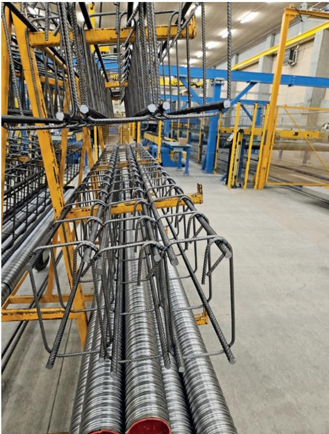
Gracias al innovador sistema de doblado, que fue integrado en la instalación de soldadura de mallas, las jaulas pueden construirse mediante doblado totalmente automático y flexible.
