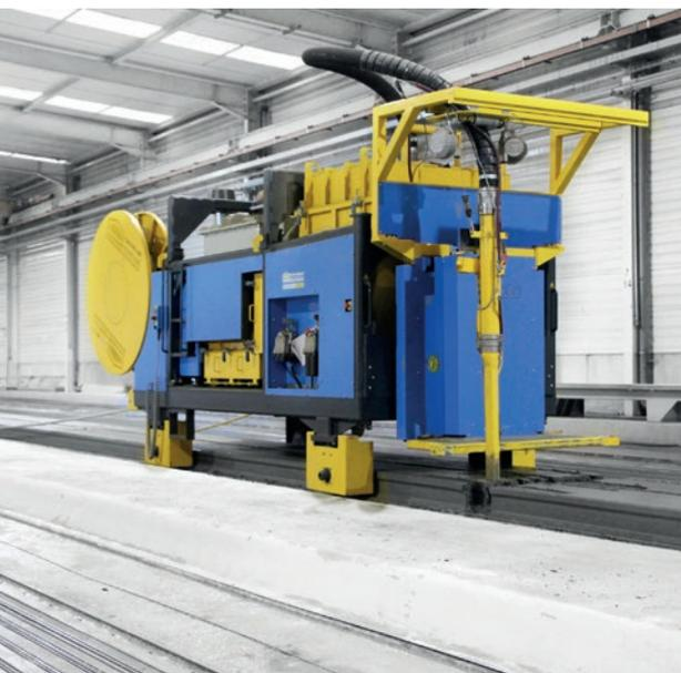
La máquina de aspirado de hormigón elimina el hormigón sobrante, aliviando el esfuerzo requerido por los empleados.
