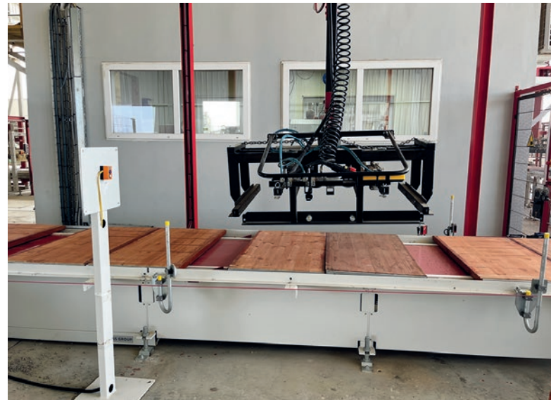
Manuell bediente, pneumatisch arbeitende 4-Seiten-Abtragezange ATZ-P4
