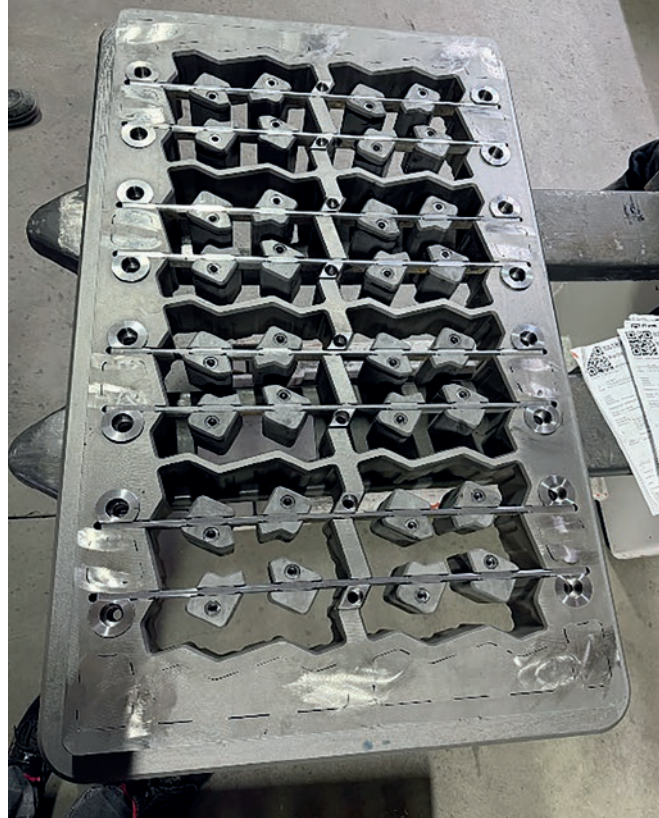
Form für Rasengittersteine mit Kernen aus recyceltem Material
