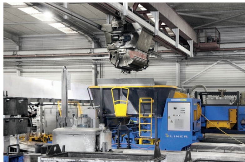
Der Gleitfertiger S-Liner® sorgt für eine automatische Produktion von Spannbetonplatten mit weniger Zement.
