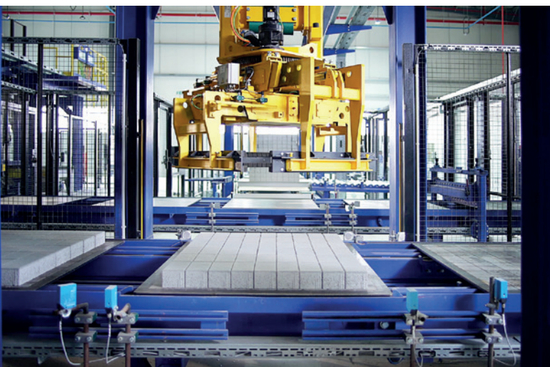
配备立方分选机的一号干区：实现素面板产品的快速分拣与精准包装
