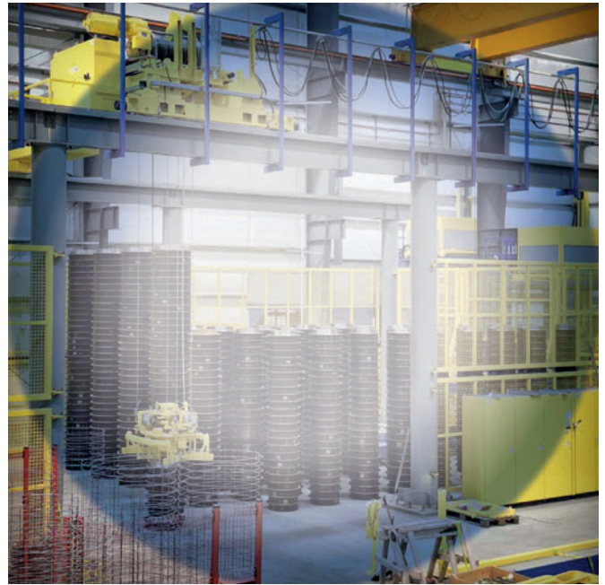
Автоматизация транспортировки муфт и подачи арматурных каркасов
