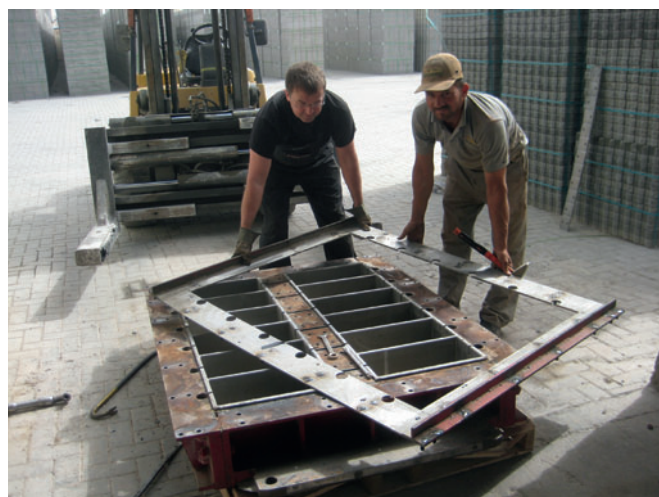
Замена изнашиваемых деталей сервисными специалистами Kobra на заводе клиента
