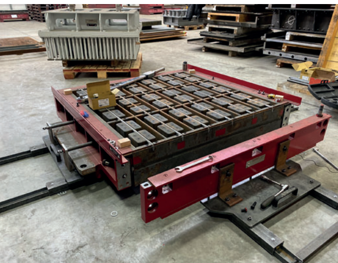
Замена вкладыша в раме Kobra
