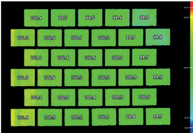
Цветовая индикация позволяет быстро и легко определить разную высоту измеряемого слоя
