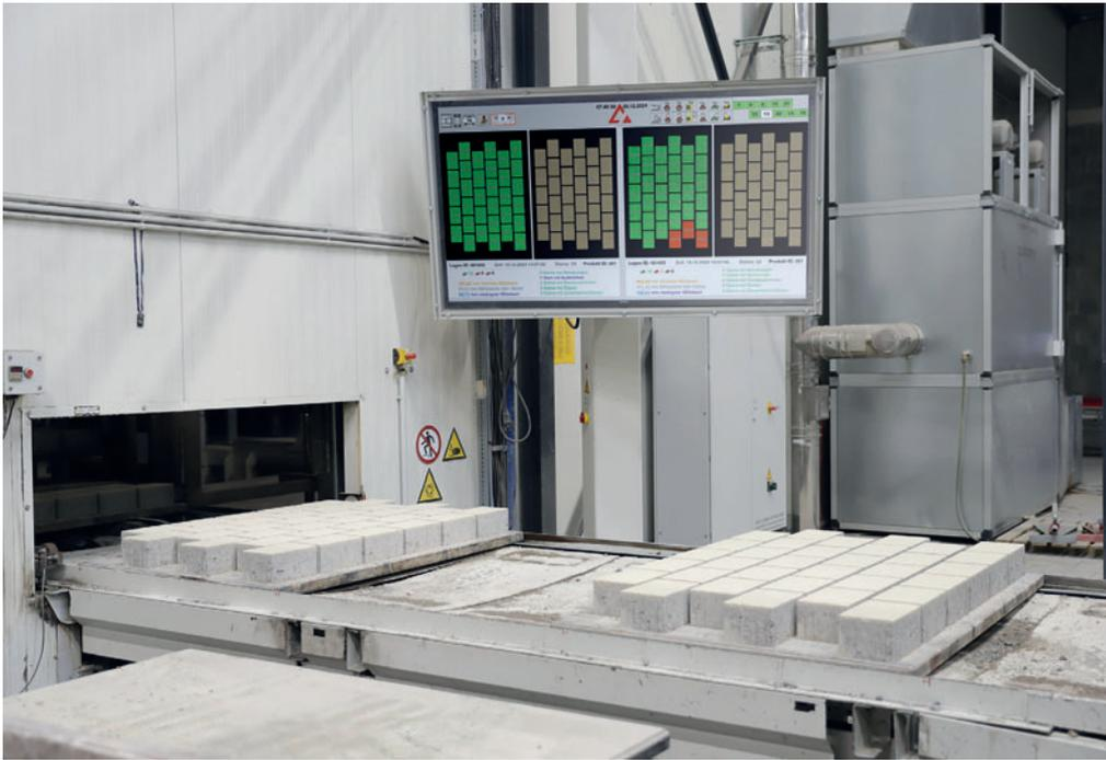
Проверка блоков с помощью системы поточного контроля качества на сухой стороне
