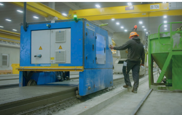
Автоматический плоттер SmartJet обеспечивает нанесение и печать данных на сборных железобетонных элементах
