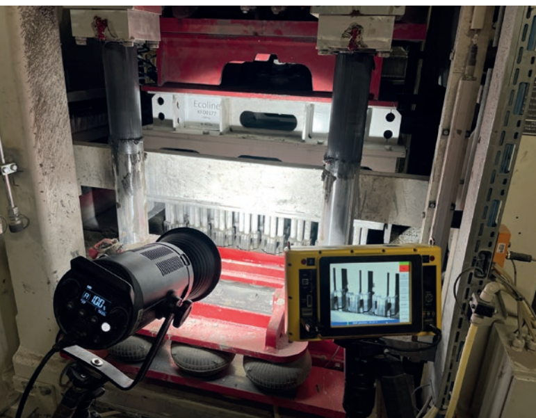
Konfiguracja kamery wysokiej prędkości.
