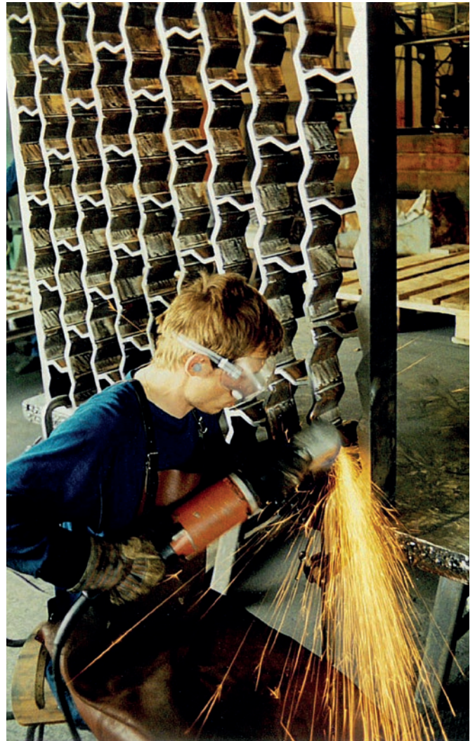
Polerowanie gniazd formy w latach 90.
