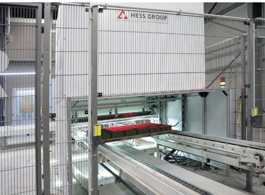
Inline QS - Prototyp systemu kamer na linii mokrej.
