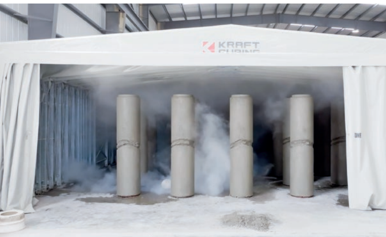
Składany namiot ze zintegrowanym systemem pielęgnacji parą wodną.
