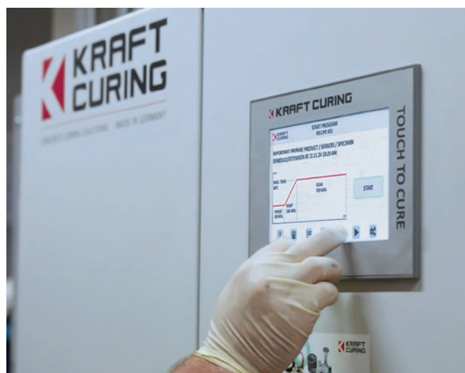
Opcja Predictive Maturity Control dla systemu kontroli jakości Match-Cure umożliwia producentom określanie optymalnego czasu rozformowania prefabrykatów lub zwalniania naciągu.
