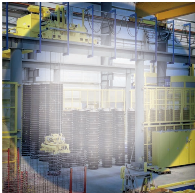
Automatyzacja obsługi podkładów i podawania koszy zbrojeniowych.
