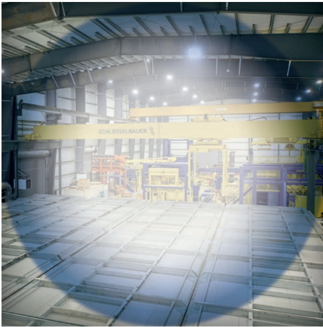
Komory dojrzewania z automatycznym załadunkiem.
