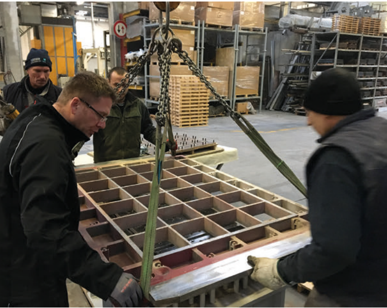
Cambio delle lastre di pressione in loco presso il client
