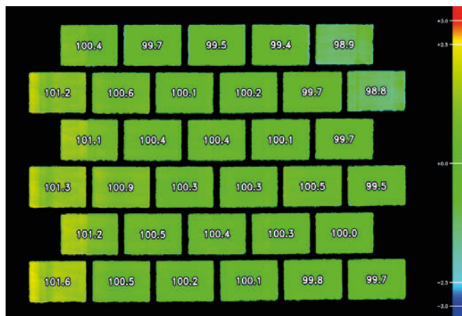
Sulla base dell'indicatore cromatico nel rilievo dell'altezza è possibile determinare in modo rapido e semplice l'andamento dell'altezza su uno strato di masselli misurato.
