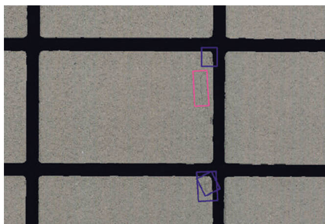
Marcatura dell'errore in rosa (fessura) e blu (scheggiatura)
