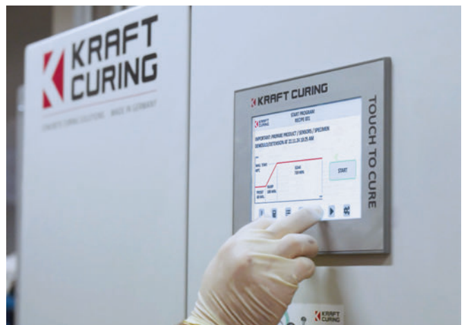
L'opzione Predictive Maturity Control Option per il sistema di controllo qualità Match-Cure consente ai produttori di determinare il momento ottimale per il disarmo oppure il rilassamento.
