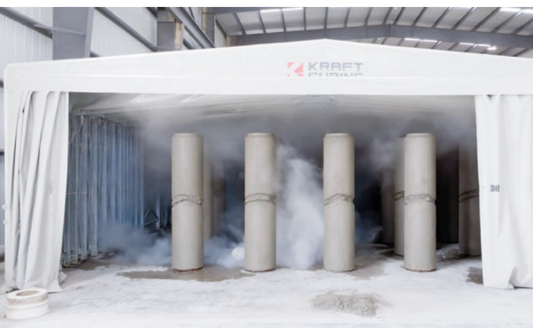
Un tendone retrattile con maturazione al vapore integrata in azione.
