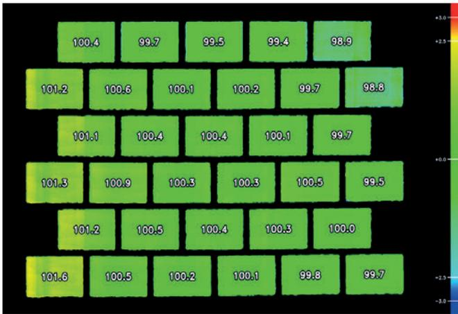
Grâce à l'indication de la couleur dans le relief de la hauteur, il est possible de déterminer rapidement et facilement les courbes de niveau sur une couche de blocs mesurée.
