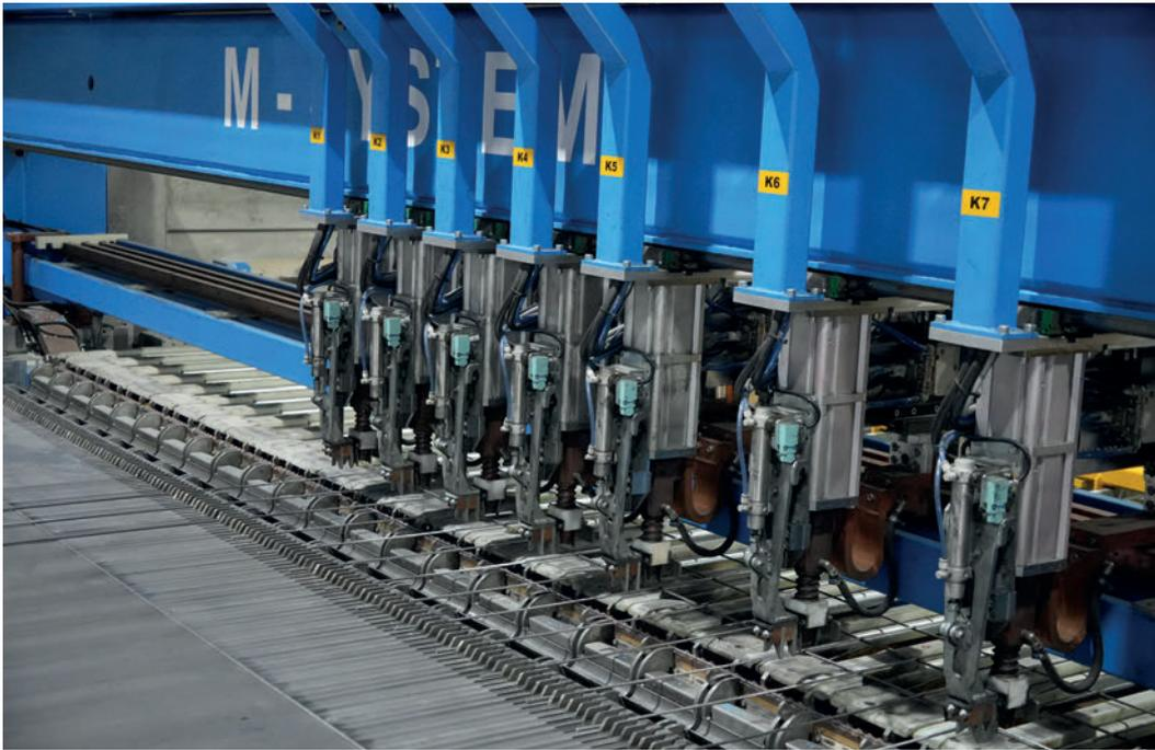
*L'installation M-System permet de souder le treillis nécessaire exactement selon le plan CAO et produit ainsi moins de déchets.*
