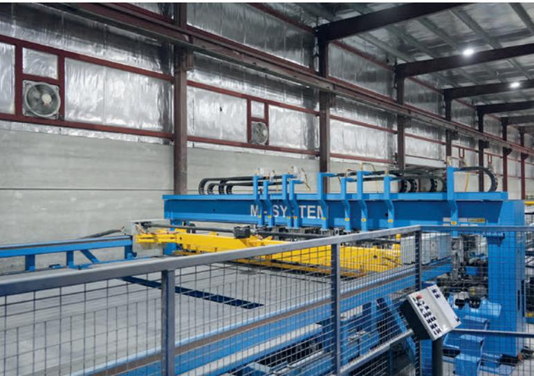
L'installation de soudage de treillis M-System est entièrement automatique et permet d'économiser beaucoup de temps et de main-d'œuvre.
