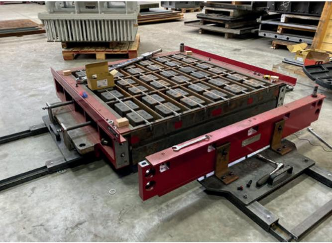
Cambio de insertos en el bastidor del sistema Kobra
