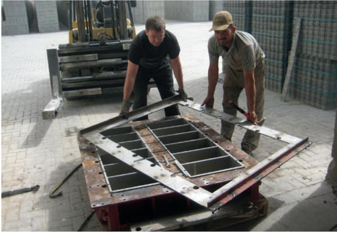
El servicio técnico de Kobra durante el cambio de una pieza de desgaste in situ
