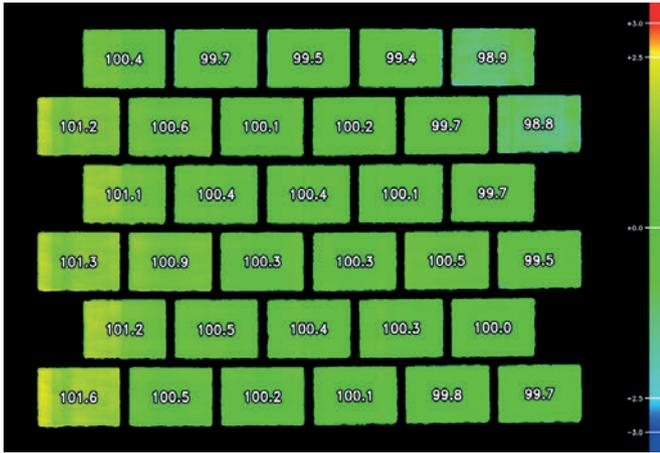
La indicación de color en relieve de altura permite determinar rápida y fácilmente los desarrollos de altura en una capa de bloques completa.
