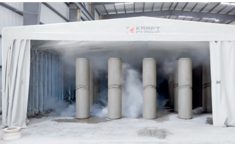
Carpa plegable con curado al vapor integrado en acción.
