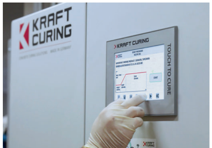
La Predictive Maturity Control Option para el sistema de control de calidad Match-Cure permite a los fabricantes determinar el momento óptimo para el desencofrado o el destensado.
