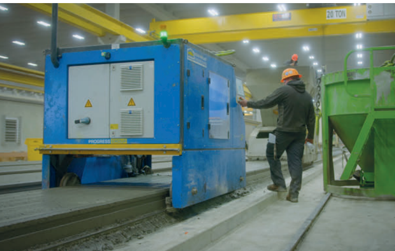
El plóter automático SmartJet permite plotear e imprimir datos en los elementos de hormigón.
