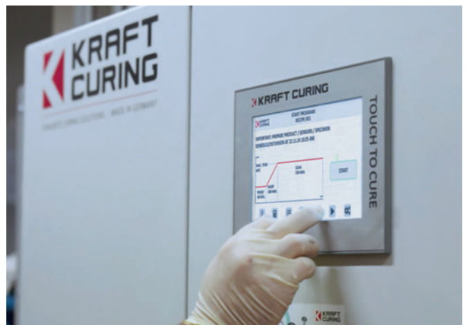
Die Predictive Maturity Control Option für das Match-Cure-Qualitätskontrollsystem ermöglicht es Herstellern, den optimalen Zeitpunkt für das Ausschalen oder das Entspannen zu bestimmen.
