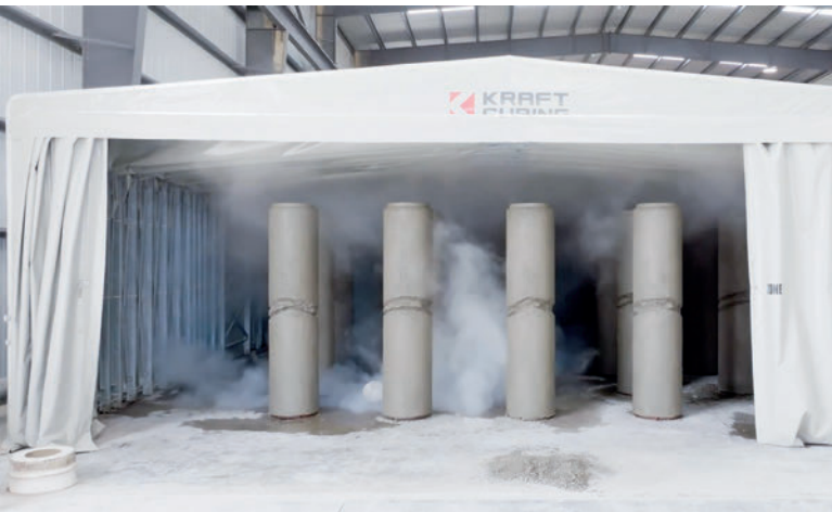
Ein einziehbares Zelt mit integrierter Vapor Härtung in Aktion.
