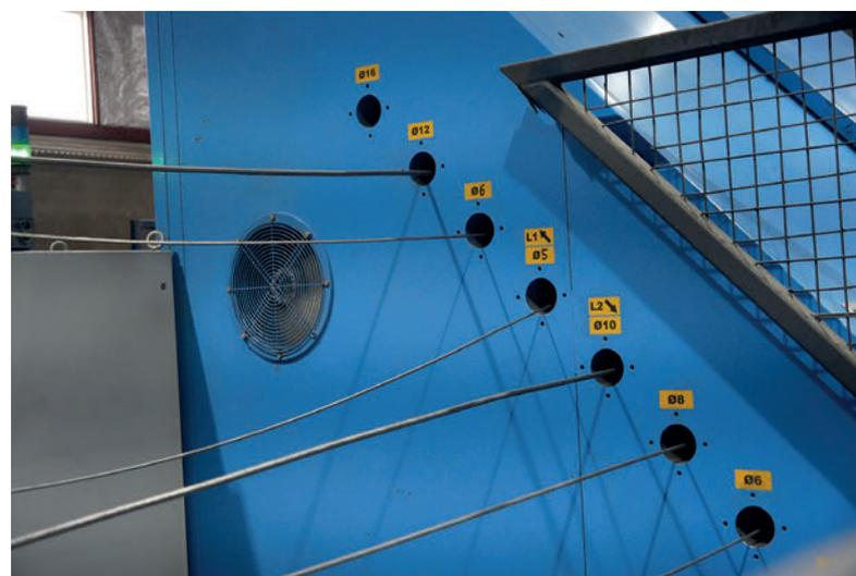
Mit verschiedenen Drahtdurchmessern können alle benötigten Bewehrungen in kurzer Zeit geschweißt werden.
