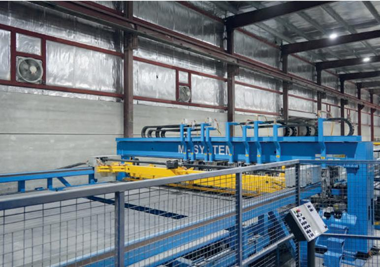
Die M-System-Mattenschweißanlage ist vollautomatisch und spart viel Zeit und Arbeitskraft.
