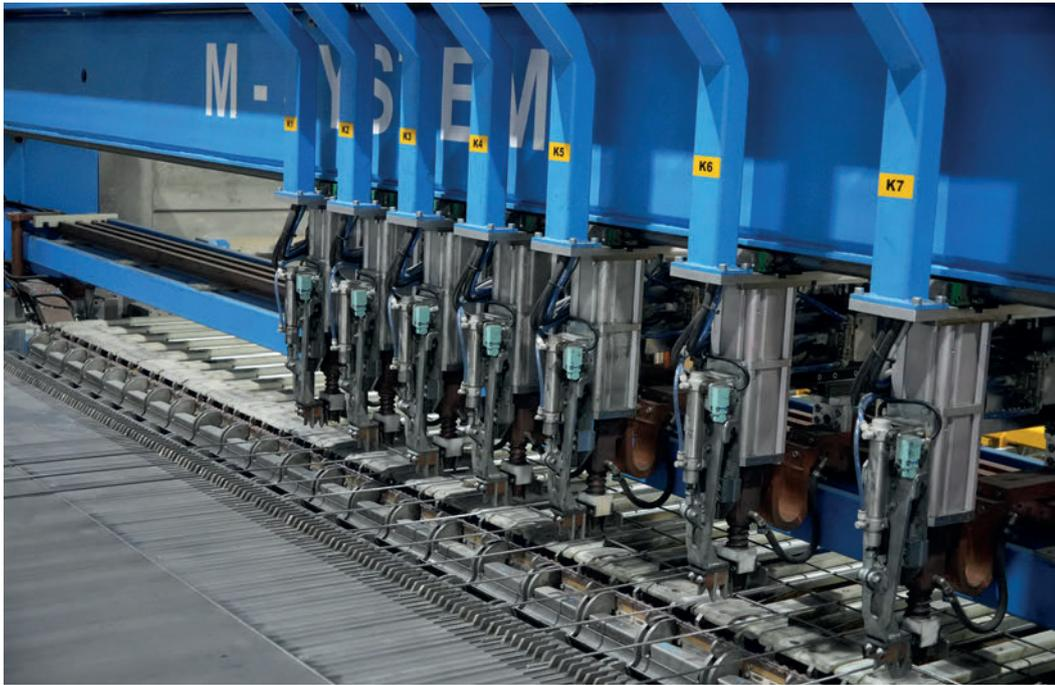
Das M-System schweißt die benötigte Matte exakt nach CAD-Plan und produziert so weniger Abfall.
