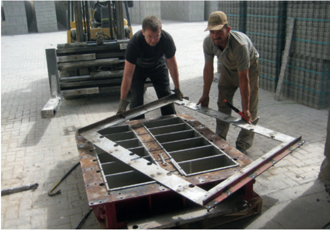
Kobra Service beim Verschleißteilwechsel vor Ort
