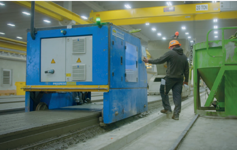
借助自动绘图机 SmartJet，可以在预制混凝土构件上绘制和打印数据
