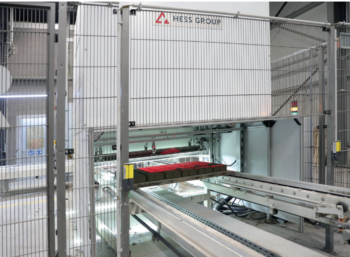
在线质量控制 - 湿侧 摄像机系统的原型
