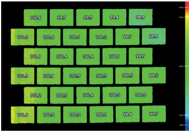
浮雕中的颜色指示可用于快速轻松地确定测量块层上的不同高度
