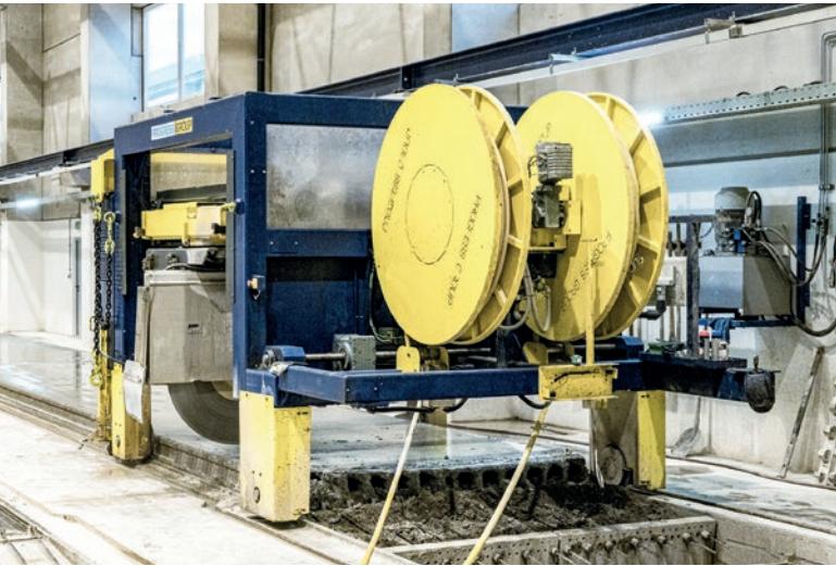
Prowadzona po szynach piła wykonuje czyste, precyzyjne cięcia w stwardniałych elementach betonowych i świeżo wyprodukowanym betonie.
