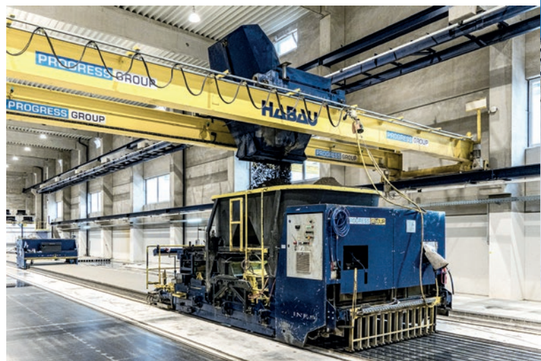
Dzięki swojej specyficznej konstrukcji i kompatybilności z mieszankami betonowymi o konsystencji wilgotnej, ślizgowy system betonowania S-Liner® jest rozwiązaniem niezwykle wydajnym pod względem kosztów, a ponadto łatwym w obsłudze i konserwacji.
