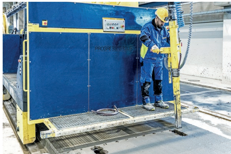
Aspirator betonu jest używany głównie do usuwania betonu z wnęk i otworów.
