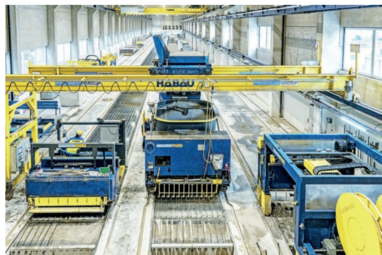
Tory o szerokości 2,40 metra umożliwiają produkcję bogatej gamy elementów betonowych - na przykład, na jednym torze można równolegle produkować dwie płyty stropowe o szerokości 1,20 metra.
