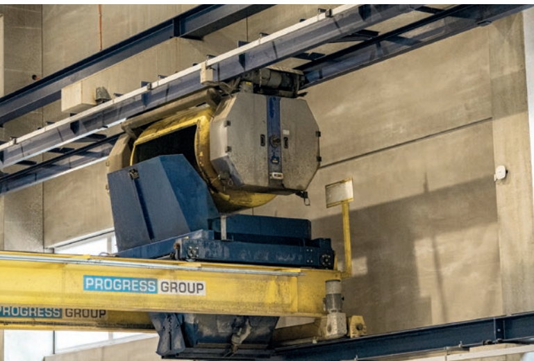
Bramowy rozścielacz mieszanki betonowej jest przeznaczony do automatycznego dostarczania betonu z systemu wózków betonu poruszających się po estakadzie.
