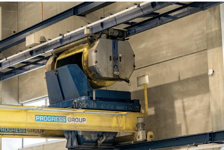
Il distributore di calcestruzzo dotato di ponte è progettato per alimentare in modo automatico il calcestruzzo fresco tramite trasportatore a vagonetti.
