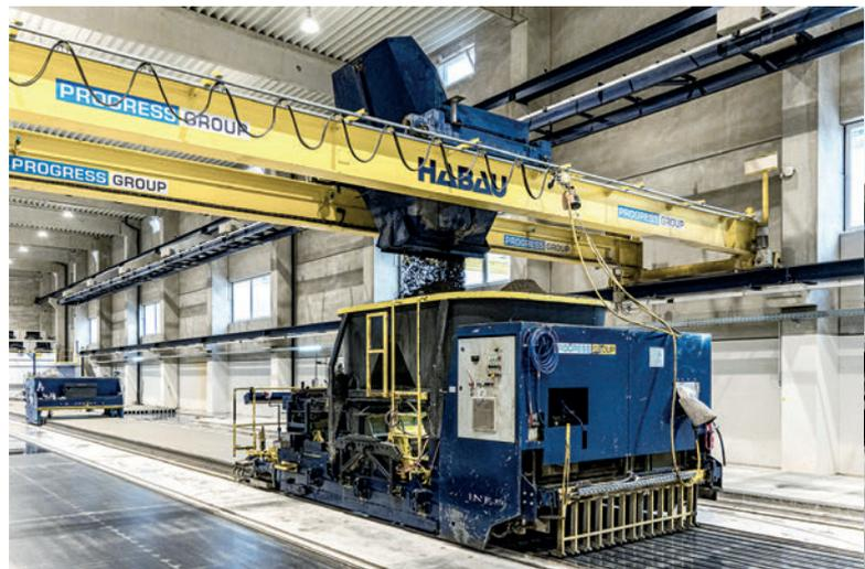
Il carrello multifunzione a batteria viene utilizzato per implementare una (nuova) pista: per la pulizia, l'oliatura e la tiratura dei trefoli tenditori/fili di ferro.
