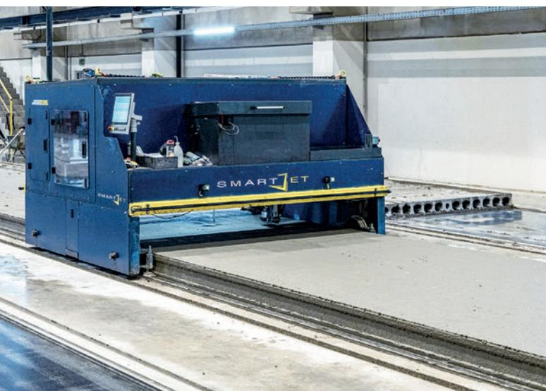
*Il plotter SmartJet oltre ad avere un dispositivo di stampa è dotato anche di dispositivo di foratura.*
