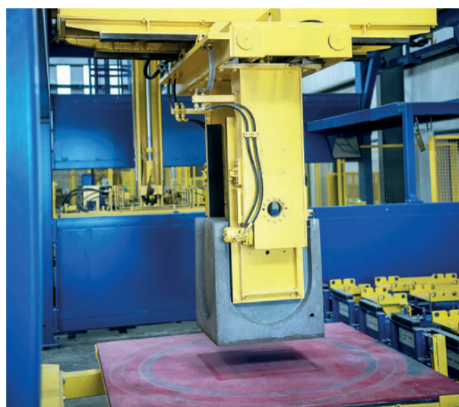
Movimentazione completamente automatica (presa, sollevamento, rotazione, posa) dei prodotti nell'impianto di pallettizzazione
