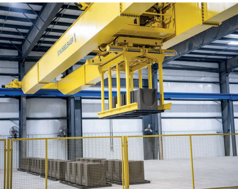
La gru Transexact trasporta i prodotti freschi nell'area di indurimento senza necessità di operatori
