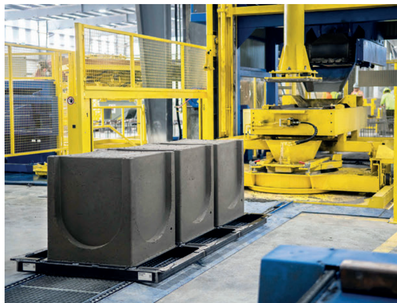
Robusti fondelli inferiori per fondi per pozzetti quadrati subito dopo il disarmo
