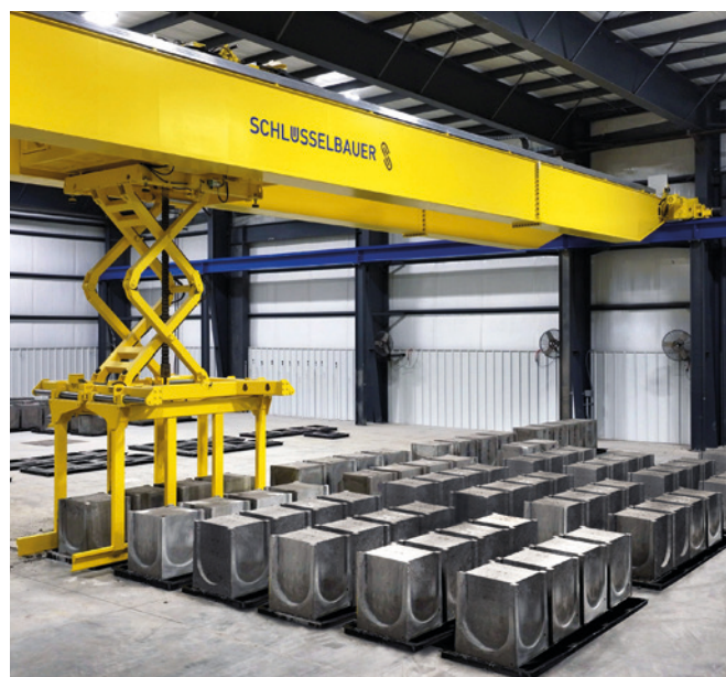
Retrait des produits durcis de la zone de séchage
