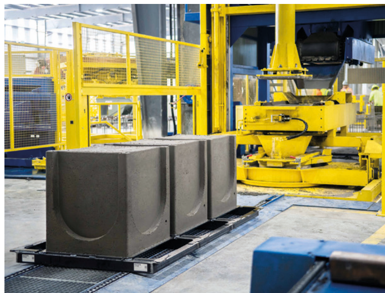
Embases stables pour fonds de regards rectangulaires à démoulage immédiat
