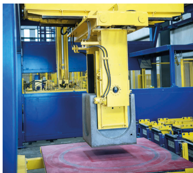
Manipulation entièrement automatisée (saisie, levage, retournement, dépose) des produits dans l'installation de palettisation
