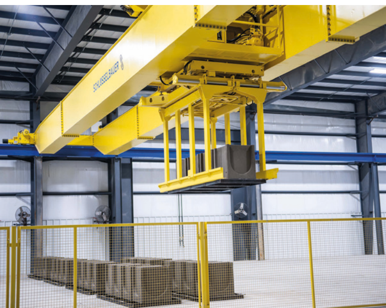
Le Transexact amène les produits frais dans la zone de séchage sans intervention humaine
