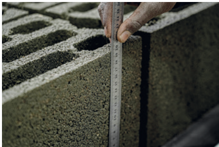
Blocs de béton fraîchement démoulés et Contrôle qualité
