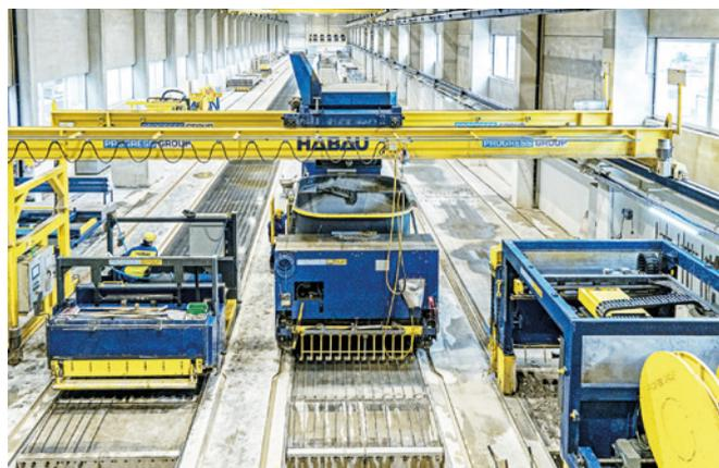
Les bandes de 2,40 m de large permettent de fabriquer les produits les plus divers - il est ainsi possible de produire deux plafonds de 1,20 m de large en parallèle sur une seule ligne.
