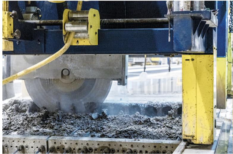
La machine à scier guidée par rail produit des coupes nettes et précises dans les éléments en béton durci ainsi que dans le béton frais.
