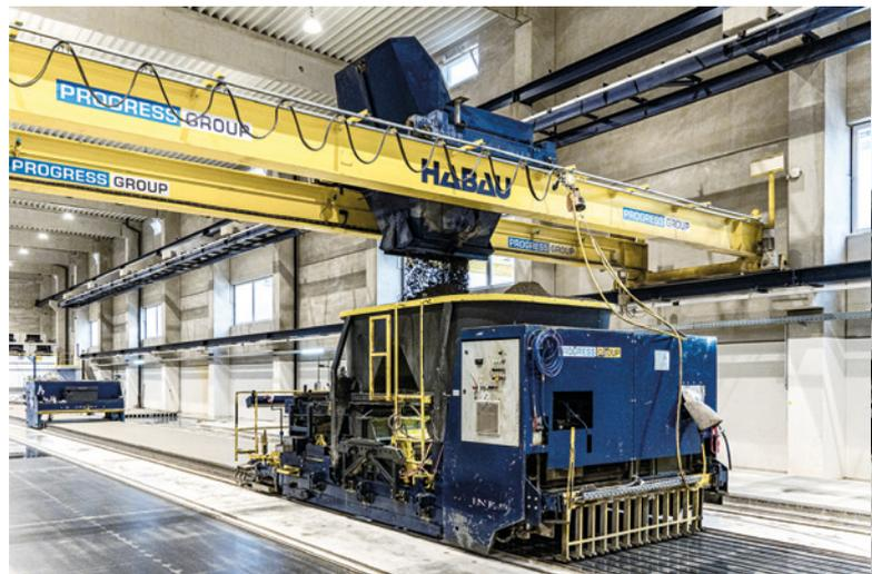
Le chariot multifonction alimenté par batterie est utilisé pour l'aménagement d'une (nouvelle) ligne : pour nettoyer, huiler et tirer les torons/fils.
