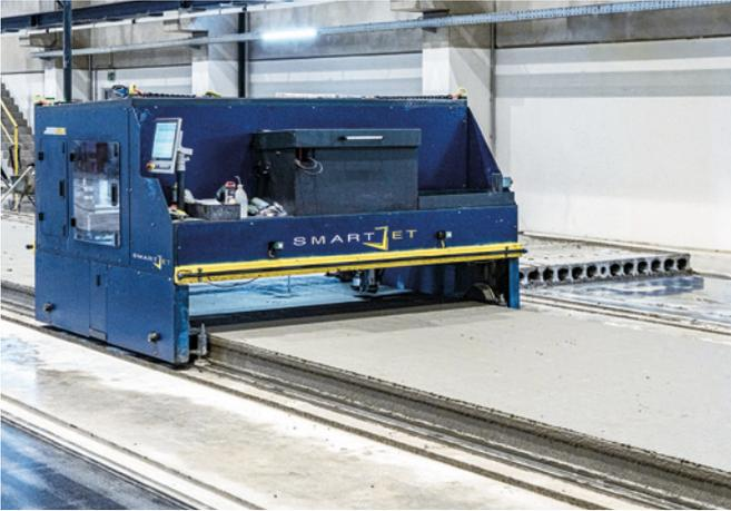
Le traceur SmartJet est équipé d'un dispositif de perçage supplémentaire en plus du dispositif d'impression.
