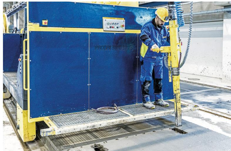
L'aspirateur à béton est utilisé en premier lieu pour enlever le béton au niveau des évidements et des ouvertures.
