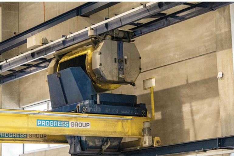
Le distributeur de béton avec pont est conçu pour une alimentation automatique en béton frais via un convoyeur à bennes.
