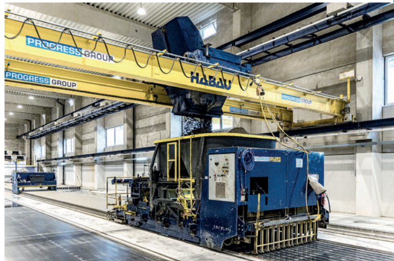
Gracias a su construcción específica y al uso de hormigón ligeramente húmedo, la máquina deslizante S-Liner® es eficiente, fácil de utilizar y de mantener.
