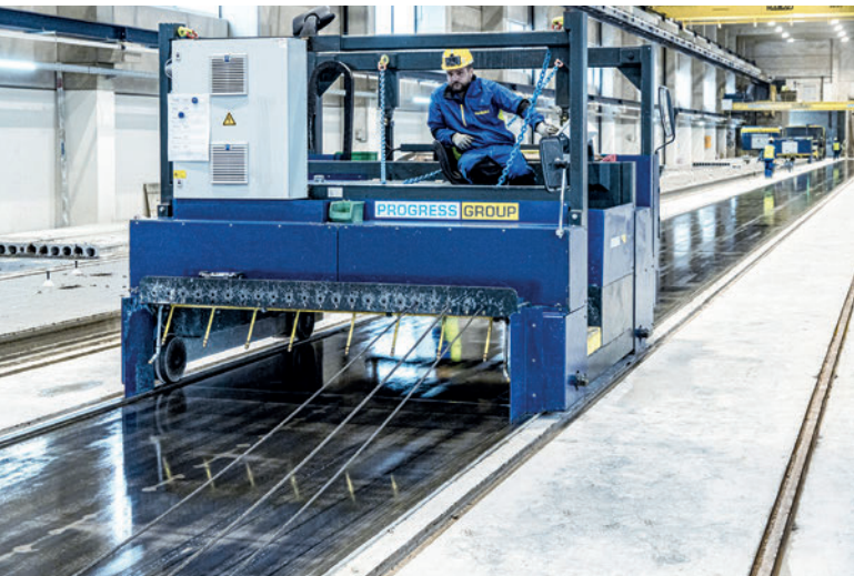
El carro multifunción alimentado por baterías se utiliza para preparar una (nueva) vía: limpia, lubrica y tiende los cordones/cables.
