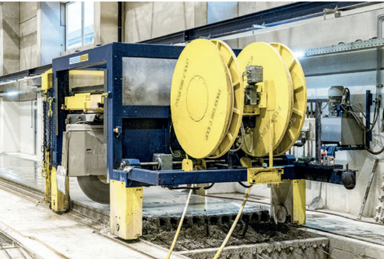
La máquina de corte guiada por railes produce cortes limpios y precisos en elementos de hormigón endurecido y hormigón fresco.
