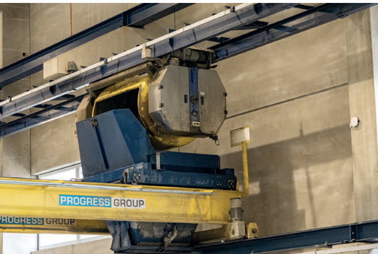
El distribuidor de hormigón con puente está diseñado para el suministro automático de hormigón fresco a través de una cuba aérea.
