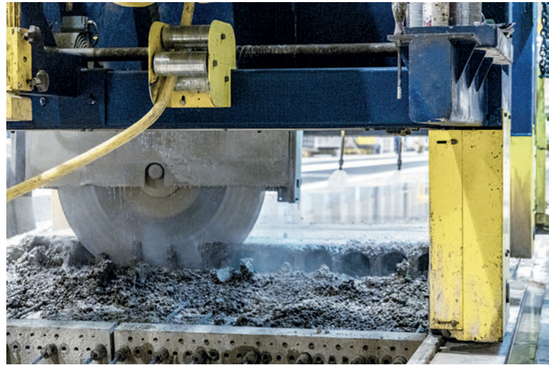
La máquina de corte guiada por railes produce cortes limpios y precisos en elementos de hormigón endurecido y hormigón fresco.
