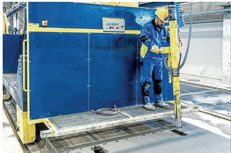
El aspirador de hormigón se utiliza principalmente para eliminar el hormigón en huecos y aberturas.
