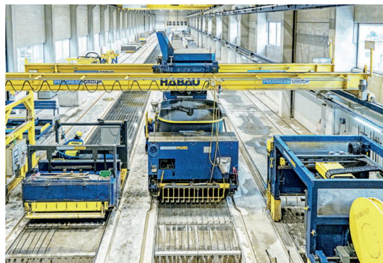
Las vías de 2,40 m de anchura hacen posible una gran variedad de productos: por ejemplo, en una vía se pueden producir en paralelo dos placas de 1,20 m de anchura.
